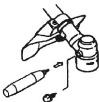
После каждых 10 часов эксплуатации бензотриммера необходимо производить проверку смазки в полости корпуса редуктора.
